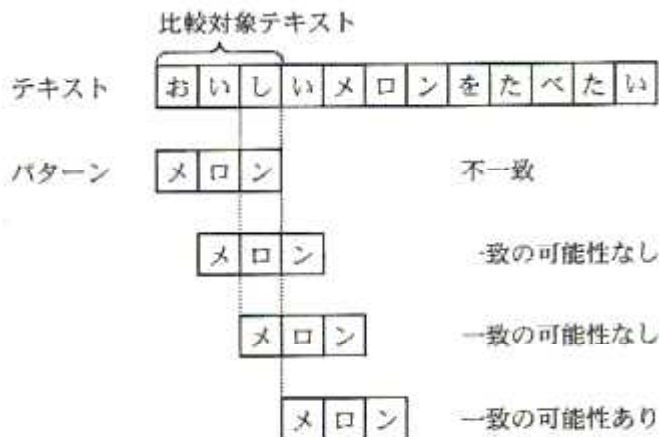
図3 比較対象テキストにパターンの文字が含まれない場合の移動
