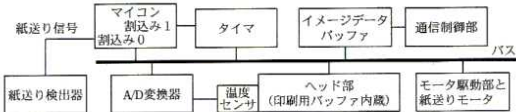
図2 ファクシミリ装置印刷部のシステム構成
