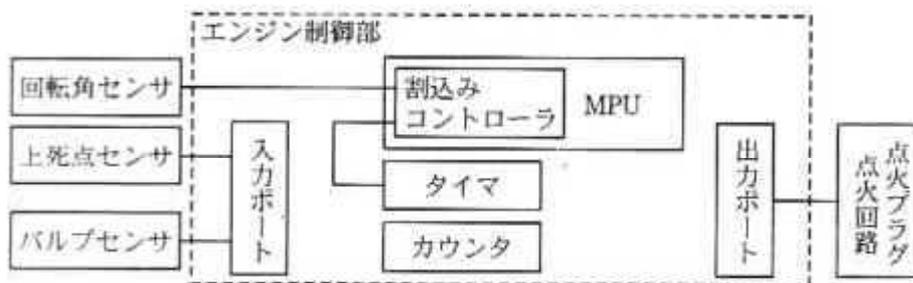
図 2 エンジン制御システムの構成
