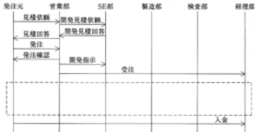
図 2 ユースケースの事象トレース図 (部分)
